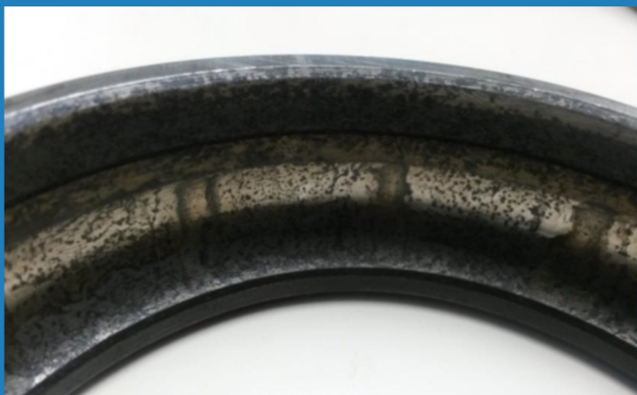
FIGURA 3. DAÑOS EN LA PISTA EXTERNA
