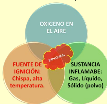
Figura 1: Se requieren tres elementos simultáneamente para producir una explosión.
