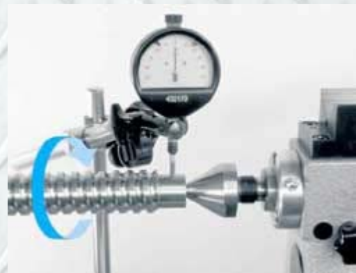
MIDIENDO EL RUN OUT CON UN COMPARADOR
