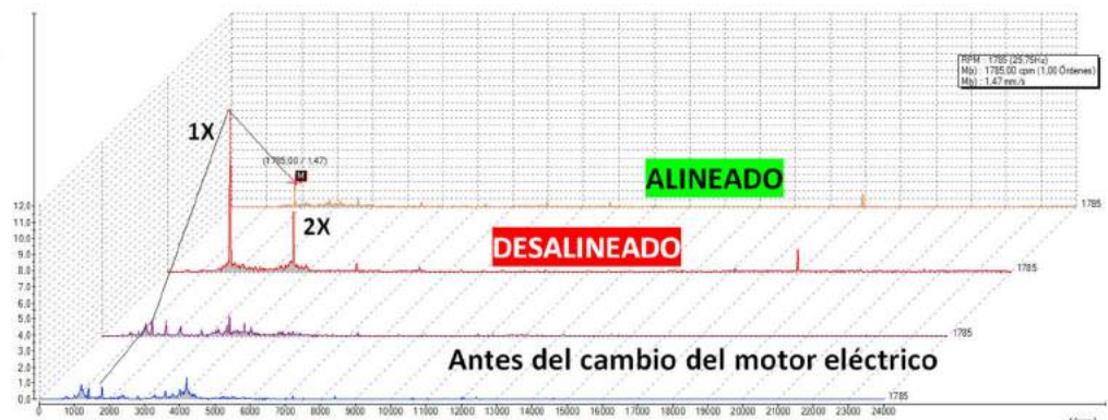
FIGURA No.1. ESPECTRO DE FRECUENCIAS PUNTO 2, MOTOR LADO ACOPLE, DIRECCIÓN AXIAL, mm/seg. PICO
